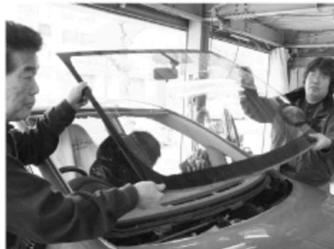
吸盤をガラスにつけて、車にフロントガラスを取り付けている作業
